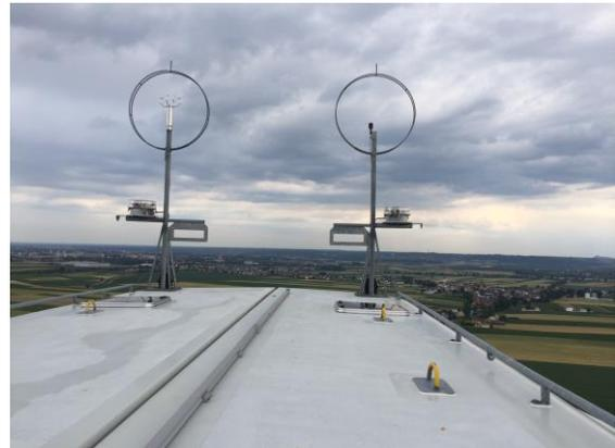
Sicht vom Gondeldach. Sensoren messen die Windstärke sowie die Windrichtung.
