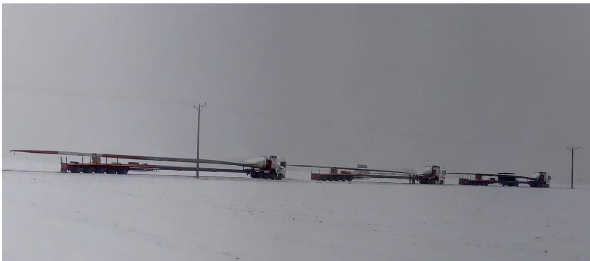
Der Transport der Rotorblätter (40m) auf dem Weg zur Baustelle in Krzanowice.
